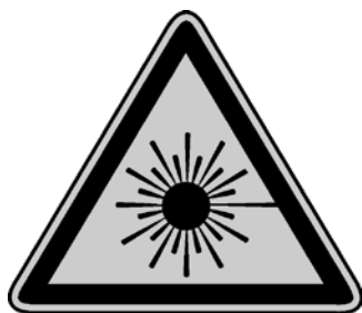
Рис. 24. Знак лазерной опасности по ГОСТ Р 50723-94
